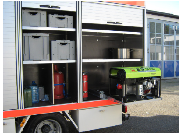
Stabiler Teleskopauszug für ein Stromaggregat. Die Staukästen können im geöffneten Zustand als Trittfläche benutzt werden.
