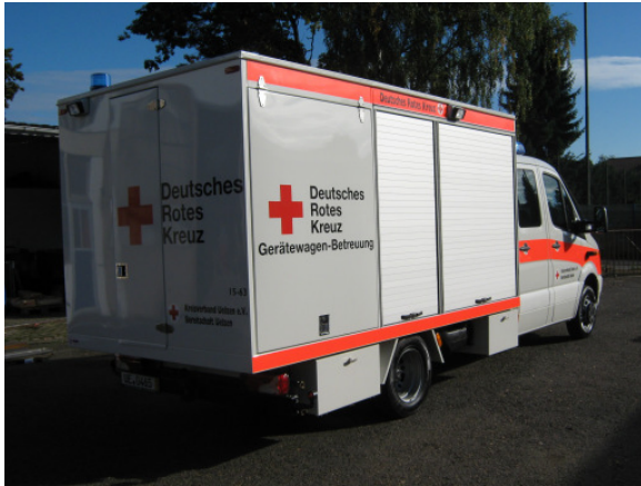
Kombination aus Klappen und Rollos Die Klappen werden mit Gasdruckfedern ausgerüstet. Die Rollos werden durch Federzugrollen unterstützt.
