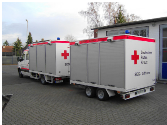
2,8 t Tandemanhänger mit Alu-Koffer Regalsysteme aus Alu-Profilen mit 15mm Siebdruckböden.
