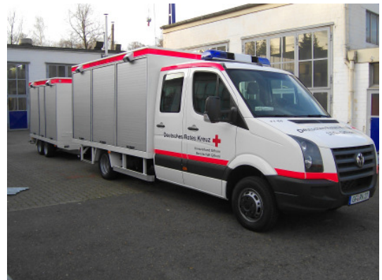
VW- Crafter 5,5 t mit Alukoffer Die seitlichen Rollos ermöglichen den Einsatz auf engen Stellplätzen.
